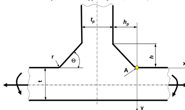
Рис. 5 Геометрия таврового сварного соединения
