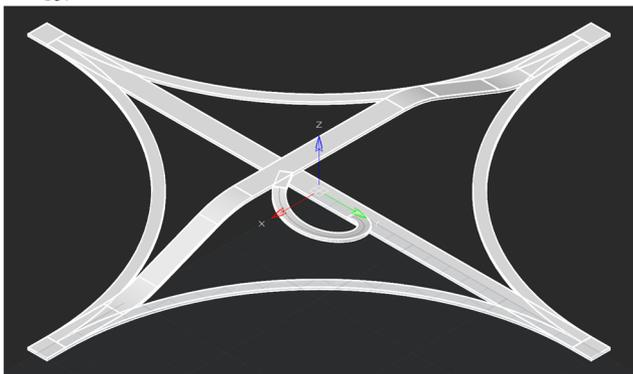
Рис. 9 Построение левоповоротного съезда как 3D объекта
