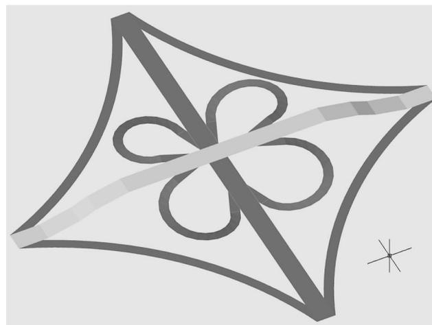
Рис. 10 Клеверная развязка, построенная средствами NanoCAD
