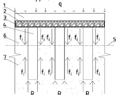
Рис. 1 – Расчетная схема работы изолированного свайно-ростверкового фундамента
