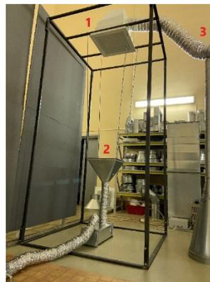
Рис. 5 – Лабораторная установка (1 – воздухоподводящий блок; 2 – имитация гранулятора; 3 – вентиляционная установка)
