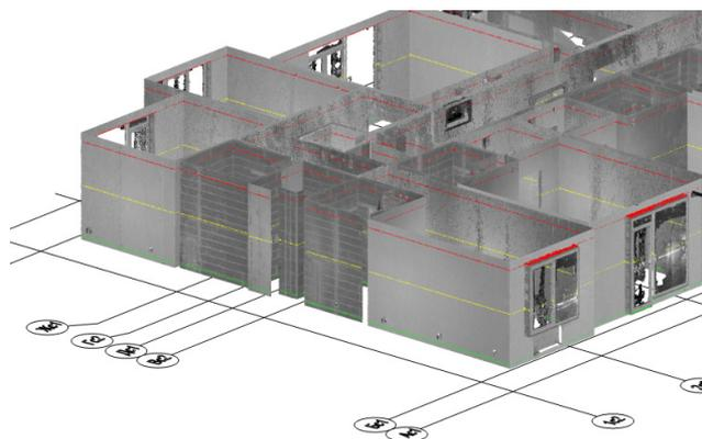
Рисунок 7. Сечения плоскостей (линии зеленого, желтого и красного цветов) чистой отделки поверхностей объекта
