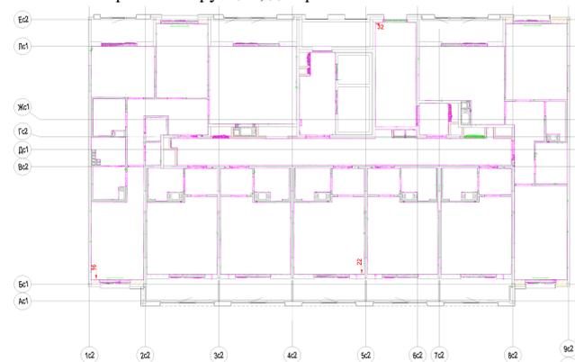
Рисунок 8. Схема анализа плоскостей чистой отделки секции здания
