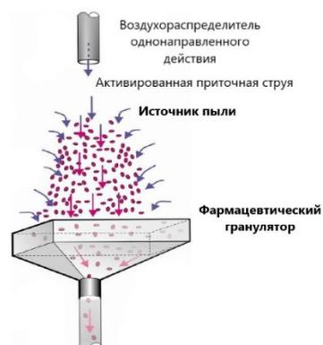
Рис.2. Воздействие активированной приточной струи на источник запыленности
