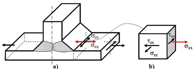
Рис. 1 Напряженное состояние в области носка сварного шва а) общая геометрия сварного соединения; б) напряженное состояние в области носка сварного шва
