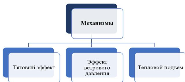
Рис. 1. Механизмы естественной вентиляции (составлено автором на основе [1, 4, 9])
