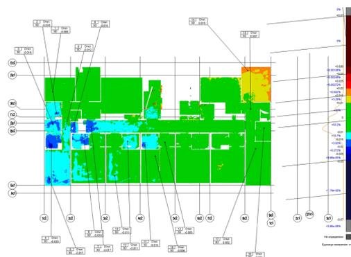
Рисунок 9. Схема анализа плоскостей чистой отделки цементной стяжки пола строящегося здания
