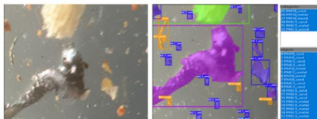
Рисунок 1 - Визуализация работы нейронной модели при распознавании образов микрокастиц строительной пыли
