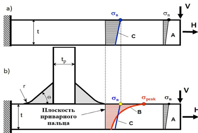
Рис. 2 Напряжения в несварной и сварной пластинах, подвергнутых идентичным внешним системам нагружения а) поля напряжений в несварной пластине; б) поля напряжений в пластине с ненагруженным односторонним креплением, соединенным галтельными швами
