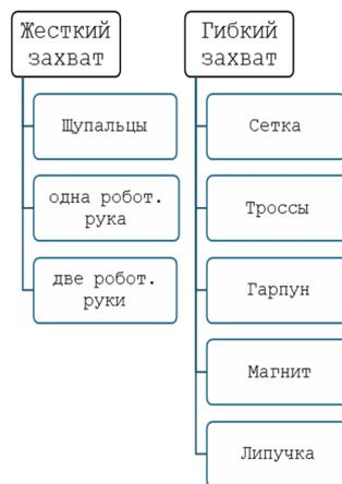
**Рис. 1.** Классификация наиболее известных контактных методов захвата
