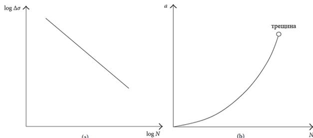
Рис. 4 Сравнение механики разрушений и  $S-N$  подходов (а)  $S-N$  кривая с заданными амплитудами напряжений в зависимости от количества вариаций напряжений; (б) размер трещины в зависимости от количества вариаций для одного испытания
