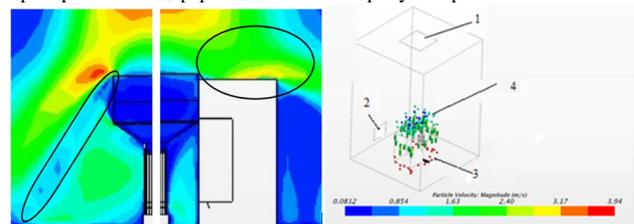
Рис.14 – Скаляр скорости распространения взвешенных частиц 5 мкм (1 – приток воздуха; 2 – вытяжка; 3 – гранулятор; 4 – облако частиц)
