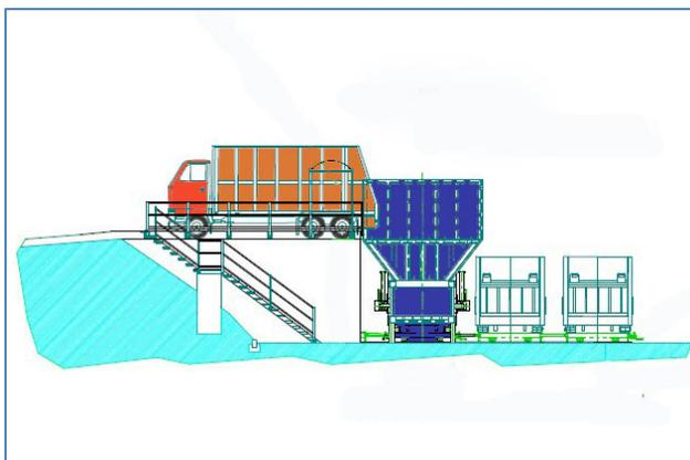
Рисунок 2. Схема погрузки ТКО на подающий конвейер
