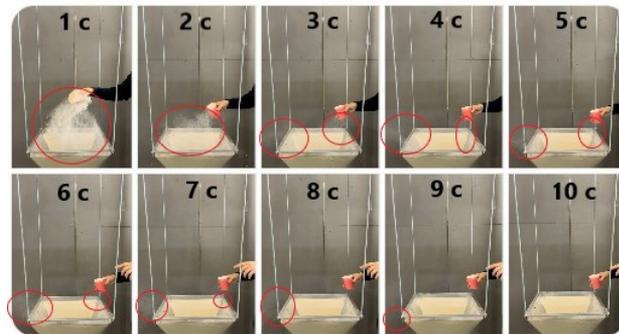
Рис.8 – Время оседания взвешенных частиц в пространстве над гранулятором
