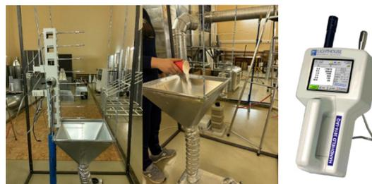
Рис. 4 – Средства измерения скорости воздуха и концентрации взвешенных частиц
